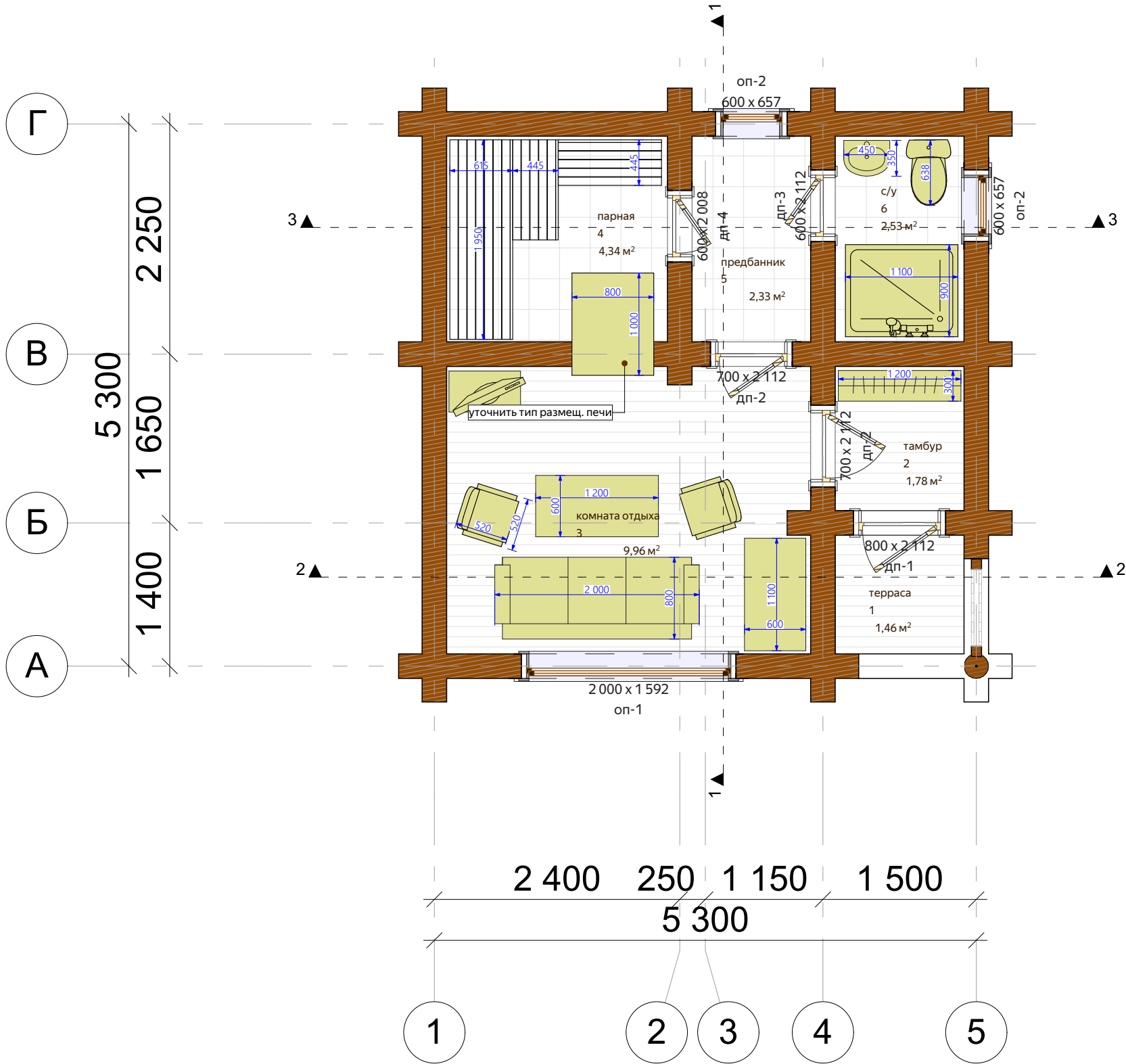
Маркировочный план сруба (М 1:50)
